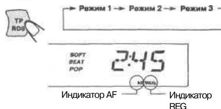
Индикатор AF горит, а индикатор REG - нет. Функция сетевого приема активизирована при включенной региональной функции. Переключение на другую станцию в пределах той же сети происходит в том случае, когда сигналы приема прослушиваемой станции становятся слишком слабыми.
