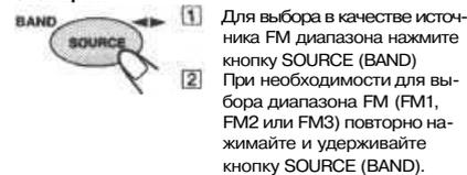
Каждый раз при нажатии и удерживании этой кнопки нажатой, изменение диапазона FM происходит в следующем порядке:
