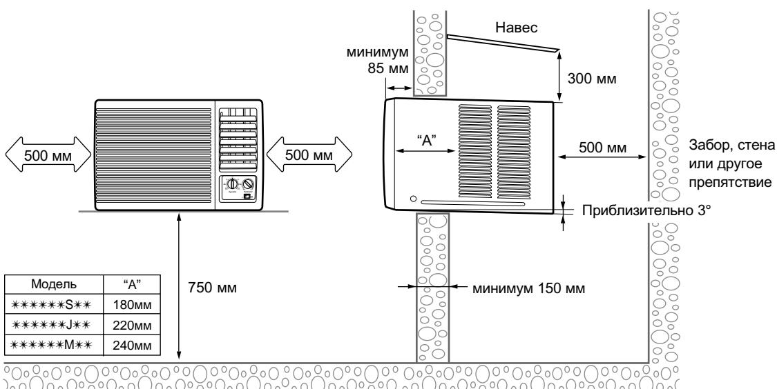
➤ ◆ Если толщина стены превышает 150 мм, подрежьте стену сзади под углом 45°, если это возможно.
