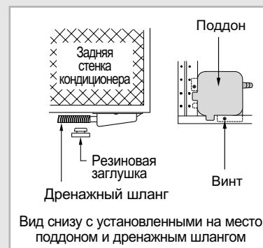
Вид снизу с установленными на место поддоном и дренажным шлангом
