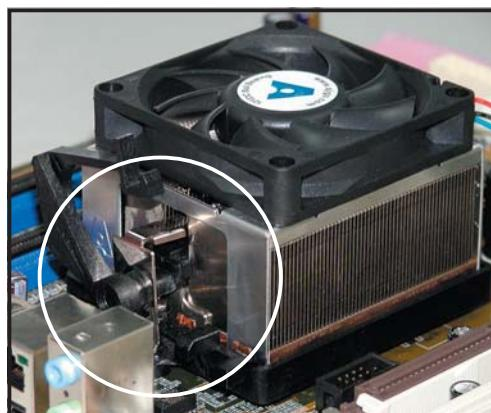
4. Drücken Sie den Hebel der Befestigungsklammer nach unten, um den Kühlkörper und Lüfter auf dem Modul zu installieren.
