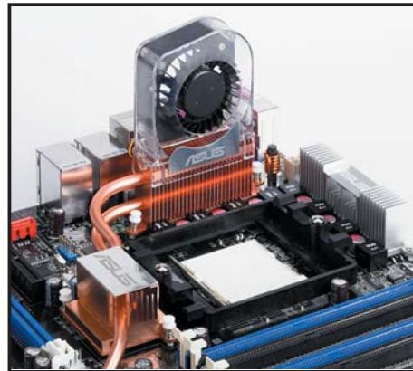
4. Das obere Bild zeigt den auf dem Kühlkörper aufgesetzten Lüfter.
