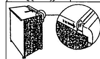
Выверните 2 верхних винта **A** и снимите крышку, движагая ее в горизонтальном направлении.
