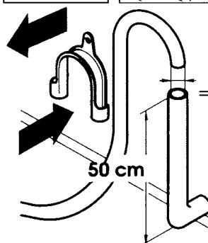
Придвиньте стиральную машину к стене. Закрепите сливной шланг на краю ванной, обращая внимание на то, чтобы отсутствовали перегибы или зажимы шланга.
