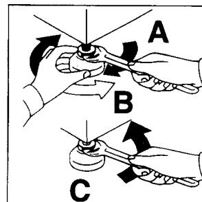
**A)** поверните по часовой стрелке гайку, чтобы разблокировать винт ножки;
