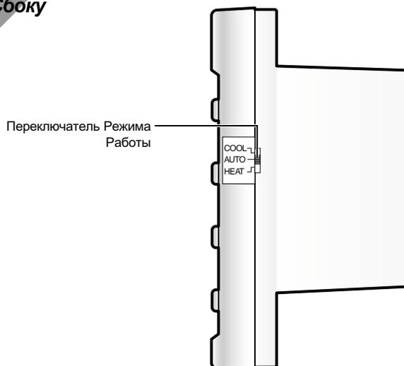
**Примечание** ♦ Выберите подходящий режим работы между Охлаждение/Авто/Обогрев на переключателе режима работы.
