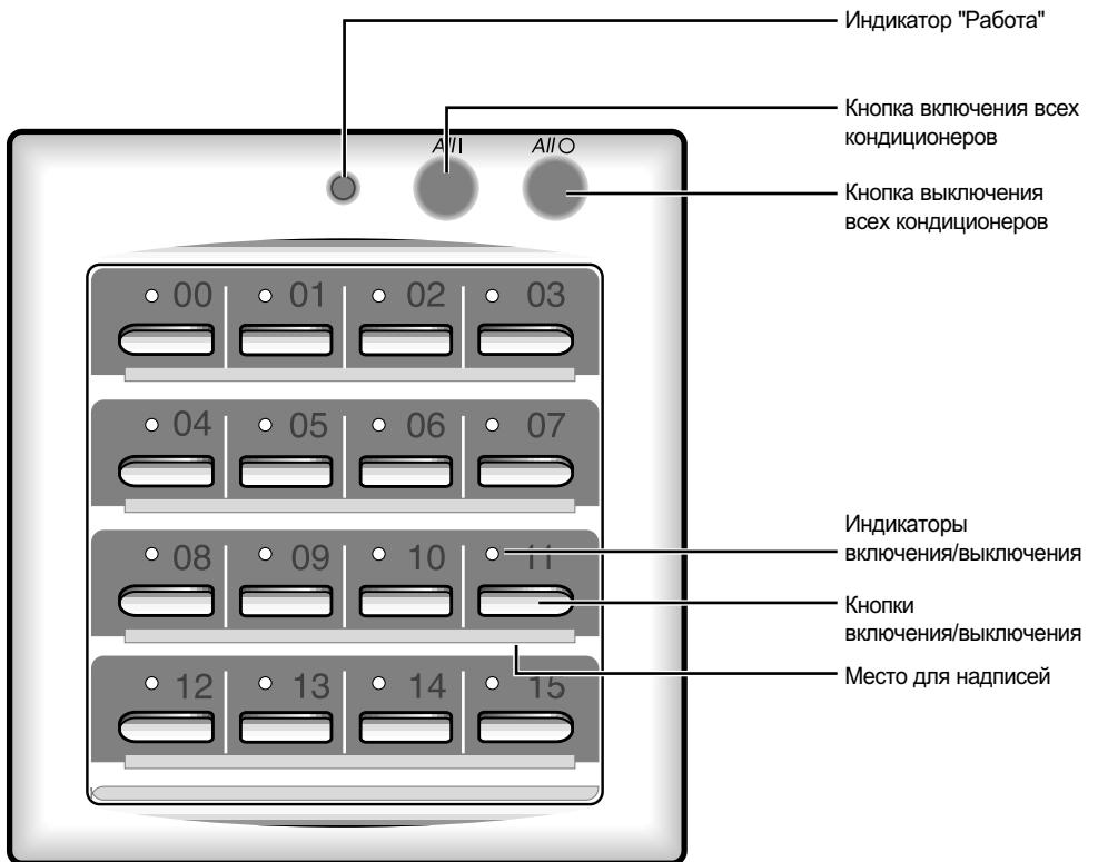
**Примечани** Индикатор "Работа" загорается, если работает хотя бы один кондиционер, подключенный к централизованному контроллеру.
