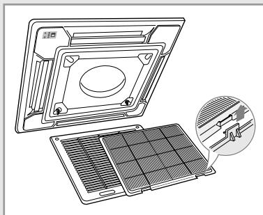
Для достижения наилучших результатов при эксплуатации вашего кондиционера, вы должны регулярно чистить его для удаления пыли, скапливающейся на воздушном фильтре.
