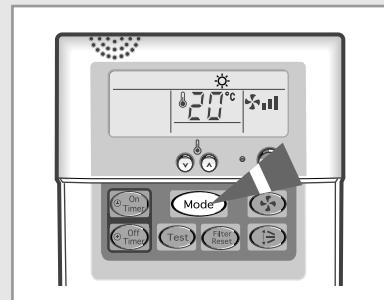
**3** Чтобы установить нужную температуру, нажмите кнопки регулировки температуры один или несколько раз, пока дисплей не покажет требующуюся температуру. Возможные температуры находятся в диапазоне от 18°C до 30°C включительно.
