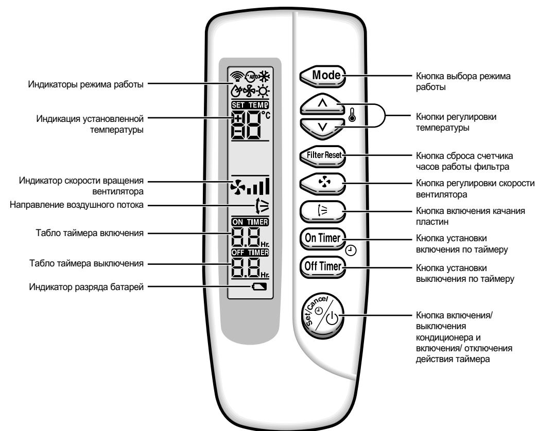
**Примечани** После чистки воздушного фильтра нажмите кнопку сброса счетчика часов работы фильтра.
