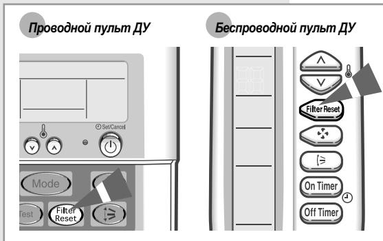
**Примечание** После чистки кондиционера нажмите кнопку сброса счетчика часов работы фильтра.
