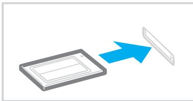
! Setzen Sie die Transportsicherung in den PC Card-Steckplatz ein, damit kein Schmutz in den Steckplatz gelangt, wenn Sie keine PC Card verwenden. Vergewissern Sie sich vor dem Transportieren des Computers, dass die Transportsicherung in den PC Card-Steckplatz eingesetzt ist.
