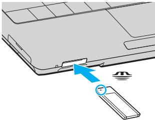
! Achten Sie beim Einsetzen des Memory Stick in den Steckplatz darauf, dass der Pfeil in die richtige Richtung zeigt. Wenn sich der Memory Stick nicht leicht einsetzen lässt, drücken Sie ihn auf keinen Fall mit Gewalt in den Steckplatz. Ihr Computer oder der Memory Stick könnte sonst beschädigt werden.
