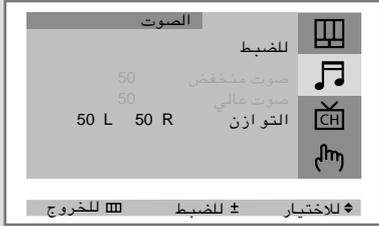
٣ اضغط على زر ▲ أو زر ▼ لاختيار "للضبط (Adjust)" أو "معدل الصوت (Equalizer)".
